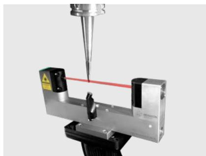
Système de mesure laser
