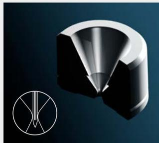
Die geschlossenen Diamantführungen lassen nur ein Spiel von  $\pm 2 \mu\text{m}$  zwischen Draht und Führung zu, um beim Verfahren der Maschinenachsen die Drahtposition optimal innerhalb der Führung zu halten.
